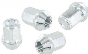
Boulons métal galvanisés de jante/roue (4 pièces) filetage M14 X 1,5, longueur 33mm, clé 19mm, tête conique 60°
