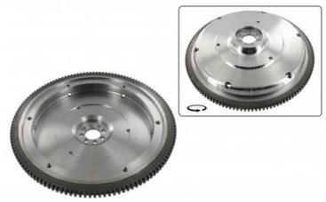
Volant moteur allégé, Moteurs type 1 1200 cc de 1980 (D 1 455 272) et après, 1500 cc, 1600 cc (Combi jusque 1975 châssis 216 2118 505), Moteurs type 3 de 8.1962 et après, Spécifications: Diamètre du disque débrayage/d'embrayage: 200mm, Dents: 130, Poids: 6,05 kg, Matériau: acier
