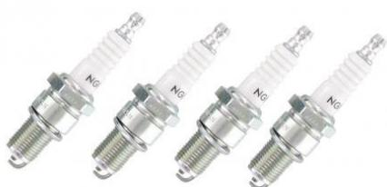
Bougies NGK BP5ES pour moteurs standards (lot de 4 pièces) Moteurs type 1 de 10.1992 et après, Moteur type 4, Moteur CT/CZ de 1980 (code moteur 065011) et après, Spécifications: Filetage et pas de vis: M14 x 1,25, Longueur du filetage: 19mm, Ouverture de la clé: 21mm, Ecartement des électrodes: 0,8mm, Indice thermique: 5
