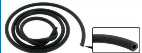
Durite/flexible d'essence avec extérieur en textile, au mètre diamètre intérieur: 5mm, diamètre extérieur: 9,5mm, pression de travail: 7 bar, pression de rupture: 30 bar, Remarque Approuvé pour l'essence fossile plombée et sans plomb E5, E10, E15, E85 et le diesel
