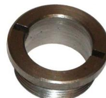
Ecroû pour fixer conduite de remplissage d'huile moteur type 1 et Ghia de 8.1960 et après (sauf 30cv), Combi 1200, 1300, 1500, 1600 de 8.1960 et après (sauf 30cv et CT), type 181
