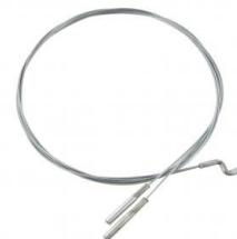
Câble de chauffage pour modèles avec transmission à cardan Cox avec carburateur de 8.1972 et après, Ghia de 8.1972 et après, type 3 de 8.1966 et après, type 181 de 2.1974 et après, Spécifications: Longueur gauche: 1375mm, Longueur droit: 1389mm
