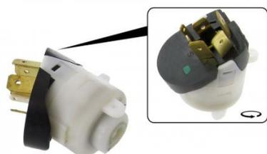
Contacteur de démarreur Cox 1300 et 1303 de 1973 (châssis 114 2358 022) et après, Cox 1200 de 8.1975 et après, Ghia de (châssis 114 144 2358 022) et après, Combi de (châssis 114 214 2164 060) et après, type 181 de (châssis 114 184 2356 316) jusqu'à
