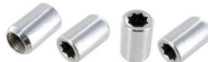
Boulons en métal chromé de jante/roue (4 pièces) filetage M14 X 1,5, longueur 31mm, diamètre 19,5mm, tête conique 60°, clé référence Paruzzi #21121
