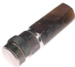
Outil pour démonter l'écrou intérieur du reniflard de 8.1960 et après sauf 30cv
