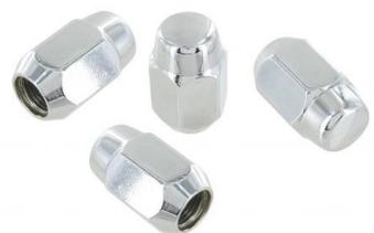
Boulons en métal chromé de jante/roue (4 pièces) filetage 1/2 pouce x 20, longueur 35mm, clé 21mm, tête conique 60°
