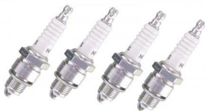
Bougies NGK BP5HS pour moteurs standards (lot de 4 pièces) Moteurs type 1 jusque 9.1992, Moteur type 3, Moteur CT/CZ jusque 1980 (code moteur M 065010), Spécifications: Filetage et pas de vis: M14 x 1,25, Longueur du filetage: 12,70mm, Ouverture de la clé: 21mm, Ecartement des électrodes: 0,7mm, Indice thermique: 5
