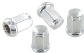
Boulons en métal chromé de jante/roue (4 pièces) filetage M14 X 1,5, longueur 34mm, clé 19mm, tête sphérique
