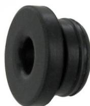
Manchon caoutchouc pour tuyau de liquide de frein ou réservoir Cox et Ghia simple circuit de 8.1966 jusque 7.1969, double circuit de 1967 (VIN 117 626 506) jusque 7.1971, Combi de 8.1966 jusque 7.1979, type 3 avec freins à disque jusque 7.1971, de 8.1971 et après uniquement pour l'avant, type 181 tous modèles, Spécifications: Intérieur: 7mm, Extérieur: 18mm
