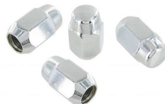
Boulons en métal chromé de jante/roue (4 pièces) filetage 7/16 pouce x 20, longueur 35mm, clé 21mm, tête conique 60°
