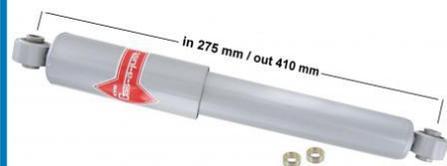
Amortisseur arrière à gaz à double tube (la pièce)
