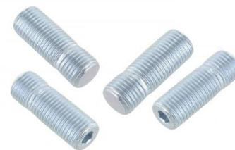
Goujons métal galvanisé de jante/roue (4 pièces) filetage M14 X 1,5 de chaque côté, longueur 38mm, longueur côté rotor 10mm, longueur côté jante 28mm, clé hexagonale 5,5mm
