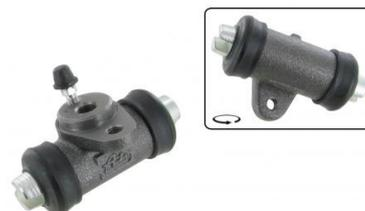
Cylindre récepteur de frein arrière, qualité A (la pièce) Cox VW1300, VW1500, 1302 et 1303 de 8.1967 et après, VW1200 de 1967 (châssis 118 328 506) et après, Ghia de 8.1967 et après, type 181 de 3.1973 et après, Spécifications: Diamètre alésage: 17,5mm
