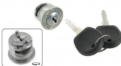
Barillet pour contacteur de démarreur Cox de 8.1966 jusque 7.1967 avec verrou de direction en option (M55) et de 8.1967 jusque 7.1970 tous les modèles, Ghia de 8.1967 jusque 7.1970, Combi de 8.1967 jusque 7.1970, type 3 de 8.1966 jusque 7.1970, type 181 jusque 7.1970
