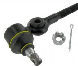
Rotule de direction avec trou pour amortisseur de direction, qualité A Cox VW1200, VW1300 et VW1500 de 1968 (châssis 118 857 2400) et après, Ghia de 1968 (châssis 148 857 240) et après, type 181, Spécifications: Filetage de la vis côté rotule: M12 x 1.5, Filet de vis côté barre: M14 x 1.5 (filetage à gauche)
