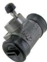
Cylindre récepteur de frein arrière, qualité A (la pièce) Combi de 4.1955 jusque 7.1971, type 181 jusque 2.1973 \*, Spécifications: Alésage: 22,2mm, Note \* s'adapte au type type 181 / Kübel jusque 2.1973 mais attention c'est du 22,2mm au lieu de 19,05mm
