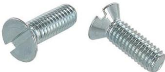
Vis du solénoïde du démarreur et de la butée de porte du portail arrière (la paire) solénoïde du démarreur Cox, Ghia, Combi refroidi par air jusqu'à 1981 (châssis 2--B-093610), type 3, type 181, Butée de porte du portail arrière Combi Pickup jusqu'à 7.1979, Spécifications: Taille du filetage: M6, Longueur: 18mm, Matériau: acier galvanisé
