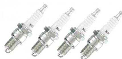
Bougies NGK BP6ES pour moteurs à haute performance (lot de 4 pièces) Moteurs type 1 de 10.1992 et après, Moteur type 4, Moteur CT/CZ de 1980 (code moteur 065011) et après, Spécifications: Filetage et pas de vis: M14 x 1,25, Longueur du filetage: 19mm, Ouverture de la clé: 21mm, Ecartement des électrodes: 0,8mm, Indice thermique: 6
