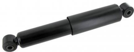
Amortisseur à huile arrière (la pièce) Cox avec essieu oscillant (trompettes) de 10.1952 et après, Ghia avec cardans (IRS) de 10.1952 et après, Combi jusque 7.1967, type 3 avec essieu oscillant (trompettes), type 181 avec essieu oscillant (trompettes), Spécifications: Enfoncé: 255mm, Étendue: 385mm
