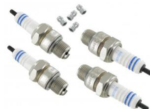
Bougies Bosch W8 AC pour moteurs standards (lot de 4 pièces) Moteurs type 1 jusque 9.1992, Moteur type 3, Spécifications: Filetage et pas de vis: M14 x 1,25, Longueur du filetage: 12,70mm, Ouverture de la clé: 21mm, Ecartement des électrodes: 0,5mm, Indice thermique: 8
