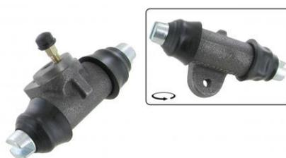
Cylindre récepteur de frein arrière, qualité B (la pièce) Cox VW1300, VW1500, 1302 et 1303 de 8.1967 et après, VW1200 de 1967 (châssis 118 328 506) et après, Ghia de 8.1967 et après, type 181 de 3.1973 et après, Spécifications: Diamètre alésage: 17,5mm
