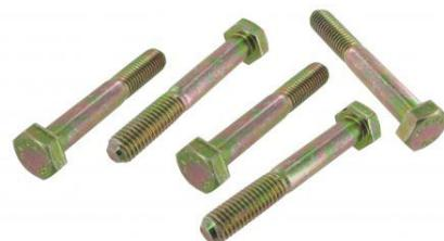
Boulons M8, lot de 5 pièces Taille du filetage: M8 x 1,25, Longueur: 55mm, Résistance à la traction: 10.9, Matériau: acier galvanisé, Taille de la clé: 13mm
