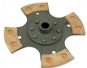
Disque débrayage/d'embrayage Feramic 200 mm
