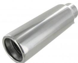
Embout/tube inox de sortie d'échappement (la pièce) remplacement pour #01063 et #01064, Spécifications: Diamètre intérieur du côté du montage: 43,5mm, Diamètre extérieur: 63,5mm, Longueur: 20,5 cm
