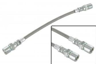
Flexible/durite de frein inox (la pièce) Cox arrière avec transmission à trompettes, Ghia arrière avec transmission à trompettes, Combi jusque 7.1967 arrière, Combi arrière côté droit de 8.1967 jusque 7.1979, type 3 arrière avec transmission à trompettes, type 181 arrière avec transmission à trompettes, Spécifications: Longueur: 270mm, Connexions: femelle/femelle M10 x 1,0
