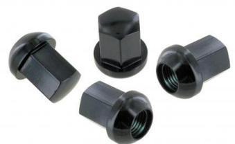
Boulons en aluminium anodisé noir de jante/roue (4 pièces) filetage M14 X 1,5, longueur 32mm, clé 19mm, tête sphérique
