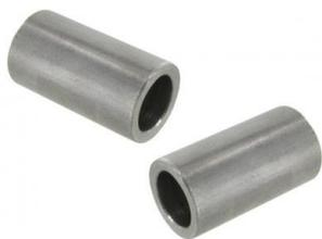
Douille de silentbloc pour amortisseurs et de barre stabilisatrice (la paire) Amortisseur Cox avant et arrière, Ghia avant et arrière et de 8.1967 jusque 7.1979 arrière, type 181 arrière, Barre stabilisatrice Cox de 1968, Ghia de 1968, type 181, Spécifications: Longueur: 32mm, Diamètre extérieur: 17mm, Diamètre intérieur: 12,5mm
