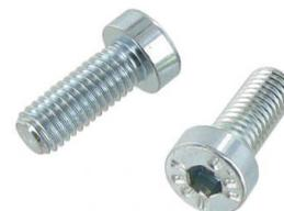
Vis à tête cylindrique à six pans creux, la paire diverses applications pour, Cox de 8.1970 et après, Ghia de 8.1970 et après, Combi de 8.1970 jusque 7.1979, type 3 de 8.1971 et après, type 181 de 1.1973 et après, Spécifications: Filetage: M8 x 1.25, Longueur: 20mm, Résistance à la traction: 8.8, Matériau: acier galvanisé, Clé: 5mm
