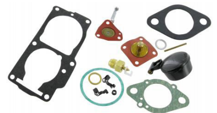
Kit de rénovation/révision pour carburateur Brosal I H32/34 PDSI-2, côté gauche
