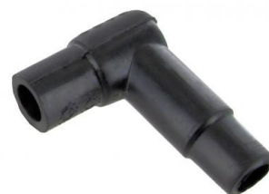
Tuyau en coude pour connexion dépression à admission (la pièce) Moteur type 4 1800 cc et 2000cc jusque 7.1979 gauche ou droit, Moteur type 4 2000 cc de 8.1979 et après droit
