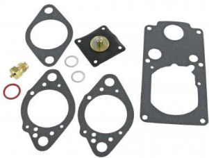
Kit de rénovation/révision pour carburateur Solex/Brosol H40-44EIS, EMPI 40K
