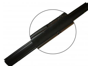
Longeron extérieur droit en dessous de la porte coulissante, qualité B Combi jusque 7.1967
