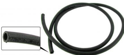
Durite/flexible d'essence avec extérieur en textile, au mètre Diamètre intérieur: 12mm, Diamètre extérieur: 17mm, Pression de travail: 7 bar, Pression de rupture: 30 bar, Approuvé pour l'essence avec ou sans plomb fossile E5, E10, E15, E85 et le diesel
