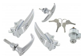
Kit serrures avec poignées de porte, contact, porte latérale et poignée de hayon arrière avec 1 clé Kombi, Microbus 9 places, Microbus Deluxe 9 places, Ambulance, de 8.1958 jusque 12.1960
