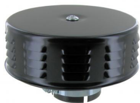
Filtre à air avec louveres Moteurs type 1 avec carburateur standard, Spécifications: Hauteur: 76mm, Diamètre: 140mm, Taille du col du carburateur: 52mm
