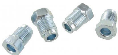
Raccords pour tuyaux de freinage (lot de 4 pièces) filetage: M10 X 1,0, diamètre intérieur: 5,15mm, dimension clé: 11mm
