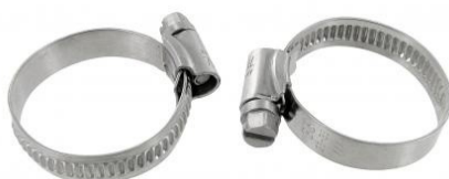
Colliers de serrage en acier inoxydable pour tuyaux d'entraînement à vis sans fin, la paire Plage de serrage: 23-35mm, Largeur: 9mm, Taille de la clé: 7mm, Matériau: RVS 316
