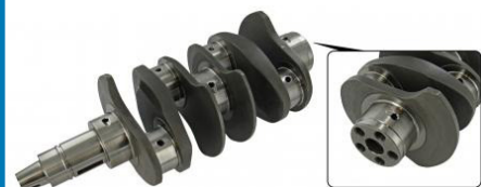
Vilebrequin à contrepoids 71 mm Moteurs type 4, Spécifications: Course: 71mm, Palier: VW 2,0 (moteur type 4), Matériau: 4340 chromoly
