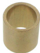
Bague standard de centrage de l'arbre du démarreur 12 volts Cox de 8.1966 et après, Ghia de 1965 et après (châssis 350 066) et après, Combi de 8.1966 et après, type 3 de 8.1966 et après, type 181, Spécifications: Diamètre intérieur: 11,0mm, Diamètre extérieur: 13,5mm
